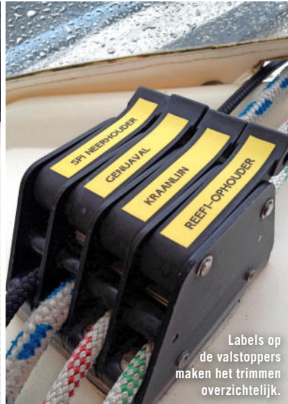
Op Fram lopen de trimlijnen vanaf de mast netjes parallel naar de valstoppers voor de lieren bij de kuip.
