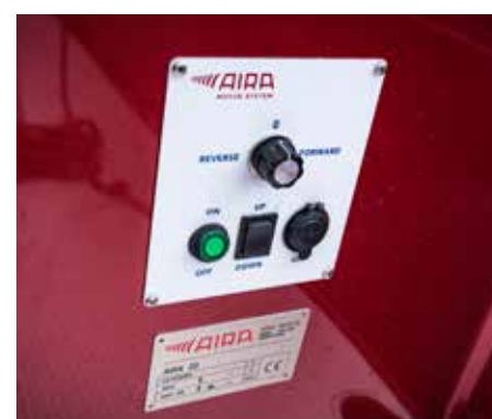
De gashendel is uitgevoerd als volumeknop en werkt alleen als de motor is neergelaten.
