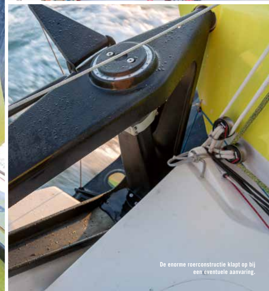
"Eerst hadden alle lijnen dezelfde kleur." Alle lijnen lopen via de koker door de kajuit naar het hart van de boot. Geen reguliere stoppers, maar een rij moderne Constrictor klemmen.
